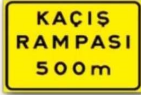
(B-55c) KAÇIŞ RAMPASI
