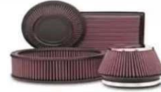
HAVA FİLTRESİ; Karbüratöre giren havayı temizler. Hava filtresi tikanırsa motor zengin karışımla çalışır. Hava filtresi kuru ve yağlı olmak üzere iki çeşittir. Kuru hava filtresi basınçlı hava ile temizlenir. Yağlı olan ise gaz yağı ile temizlenir. Servis kitabında belirtilen km'lerde değiştirilir.
